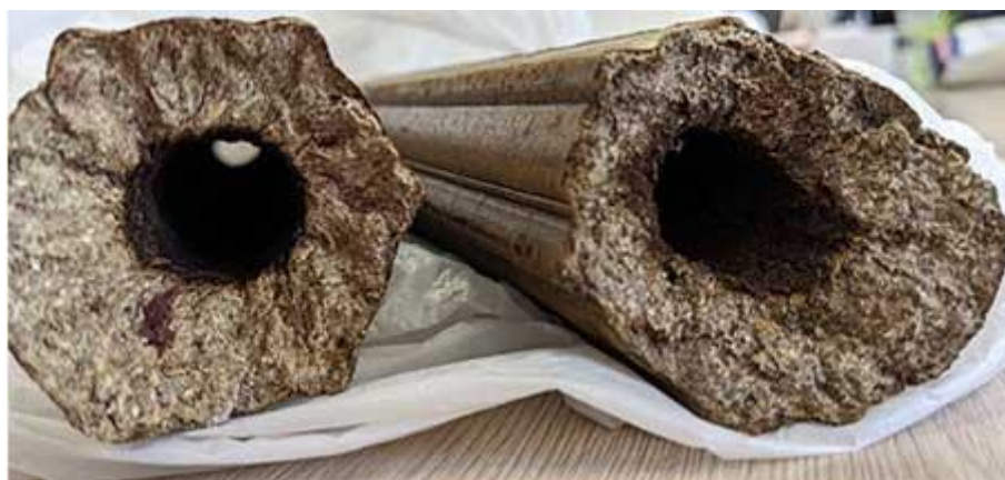
Рис. 1. Брикеты, состоящие из отходов лесопиления (1) и с добавлением органических отходов кроличьих ферм (2).
